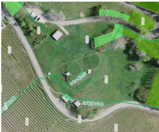
Le premier gros réservoir de 1000 m<sup>3</sup> et un second plus petit de 500 m<sup>3</sup> qui est l'ancien réservoir de 1949. L'idée est de le mettre hors service du réseau d'eau mais de le conserver sous réserve d'eau.
